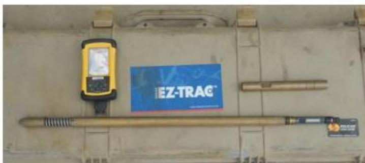
Figura 6: Equipamento de Perfilagem: Palmtop, Maleta Reflex e Conjunto de hastes
