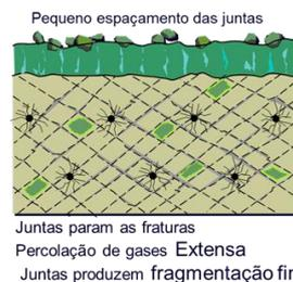
TÉRMINO PREMATURO DA PROPAGAÇÃO DAS FRATURAS RADIAIS DEVIDO A FALHAS NA ROCHA
