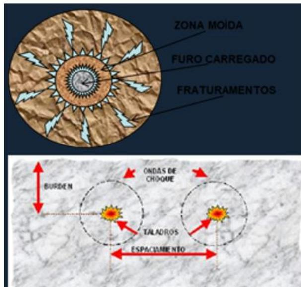
Quando a onda de choque chega a face livre, ela é refletida nessa superfície, retornando para o interior da rocha, e agora fazendo um esforço contrario de pressão, frente as ondas que seguem comprimindo a rocha, ela gera forças de tração e cisalhamento na rocha, que normalmente tem uma resistência a esse tipo de esforço bem menor, e assim começamos a nossa segunda fase do processo de fragmentação.
